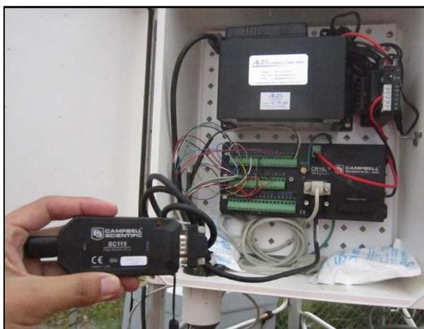
Figura N°02: Vista de conexión del USB SC115
