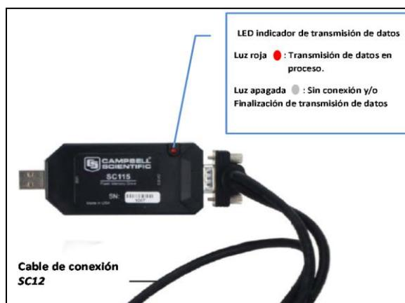
Figura N°03: Vista de Luces Indicadores del USB SC115
