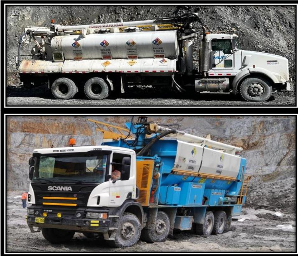
**Fig.6.4.1 Camiones Fabrica de explosivos MMU**
