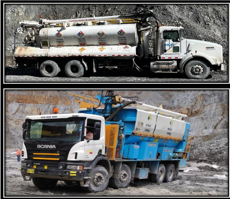
Fig.6.4.1 Camiones Fabrica de explosivos MMU
