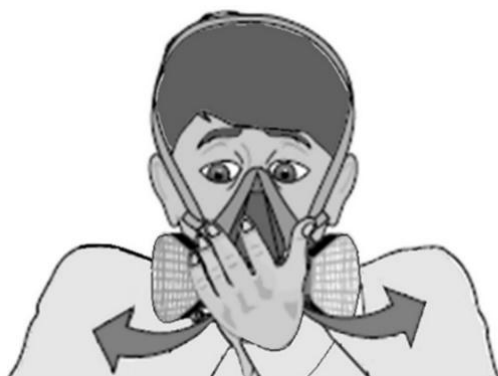
Prueba de presión positiva de respiradores
