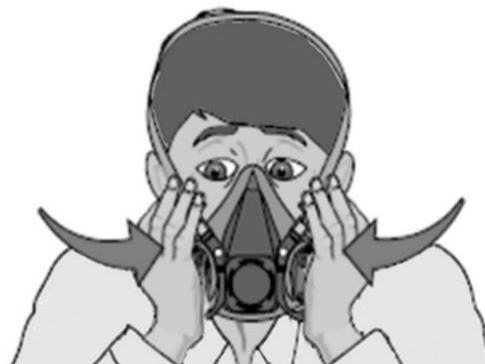
Prueba de presión negativa de respiradores
